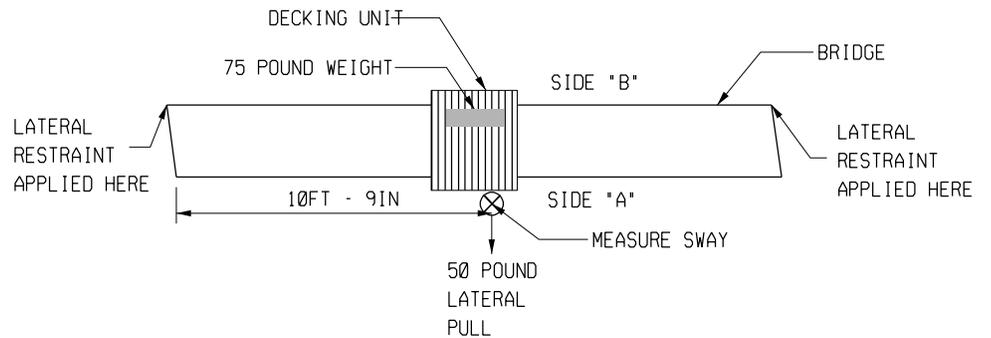
**B** LATERAL LOAD TEST - PLAN
